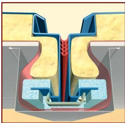
**DE:** Dachtunnel mit aufgesetzter Lippendichtung montieren. Eventuell verbleibende Fugen mit mitgeliefertem Silicon verschließen.
