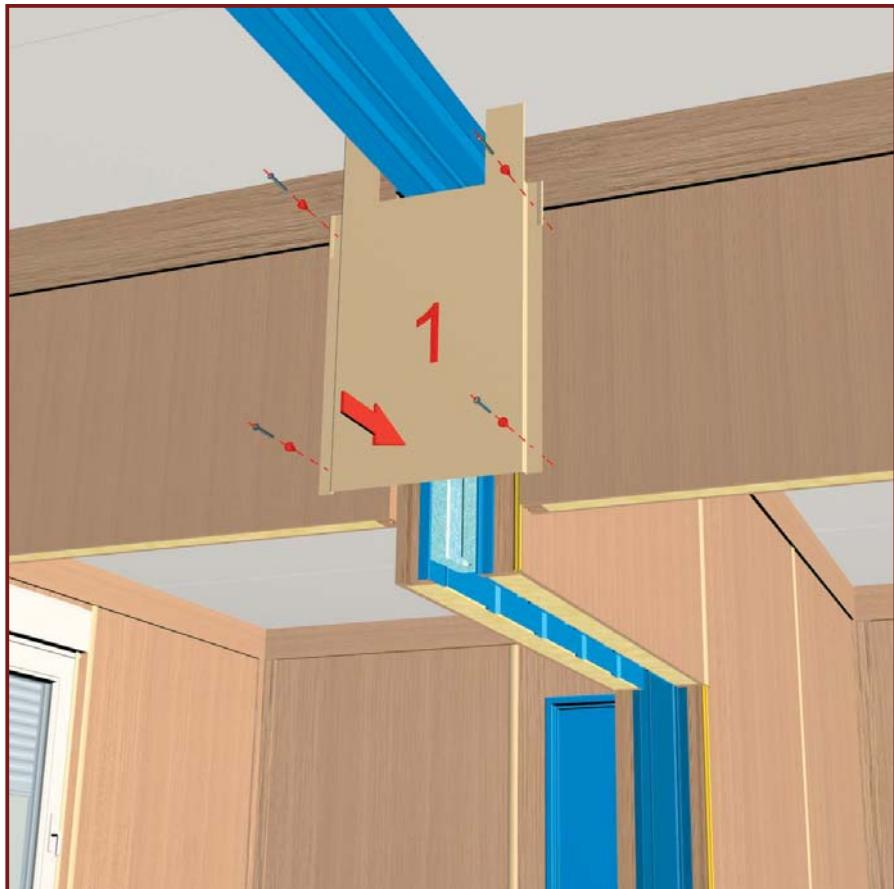
**DE:** 3.) Gangverbindung mit zwei Trennwänden
