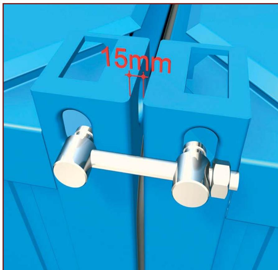
**DE:** Beide Container mit 4 Spannschrauben auf 15 mm zusammenziehen.
