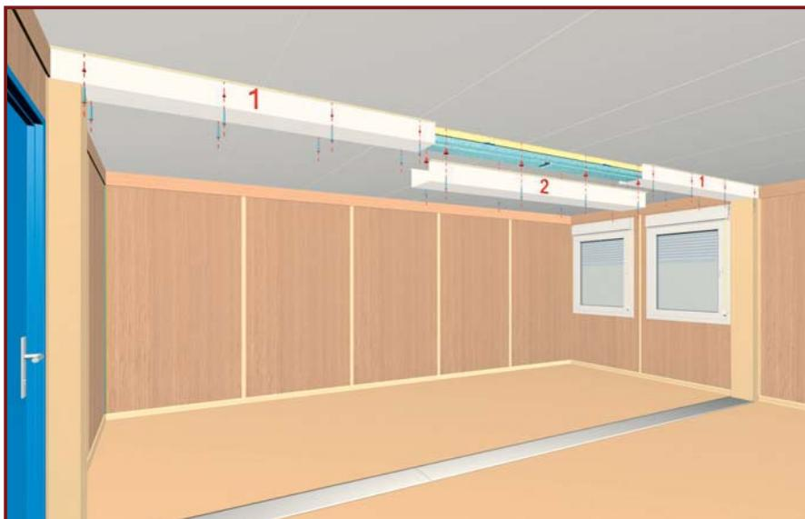
**HU:** Késsel vágjon lyukat a styroporhabon a szorítóelemeknél és csavarozza össze a kereszttartó idomokat. A szigetelőfólia széleit egymásra borítva ragassza össze szalagragaszträgtől.
