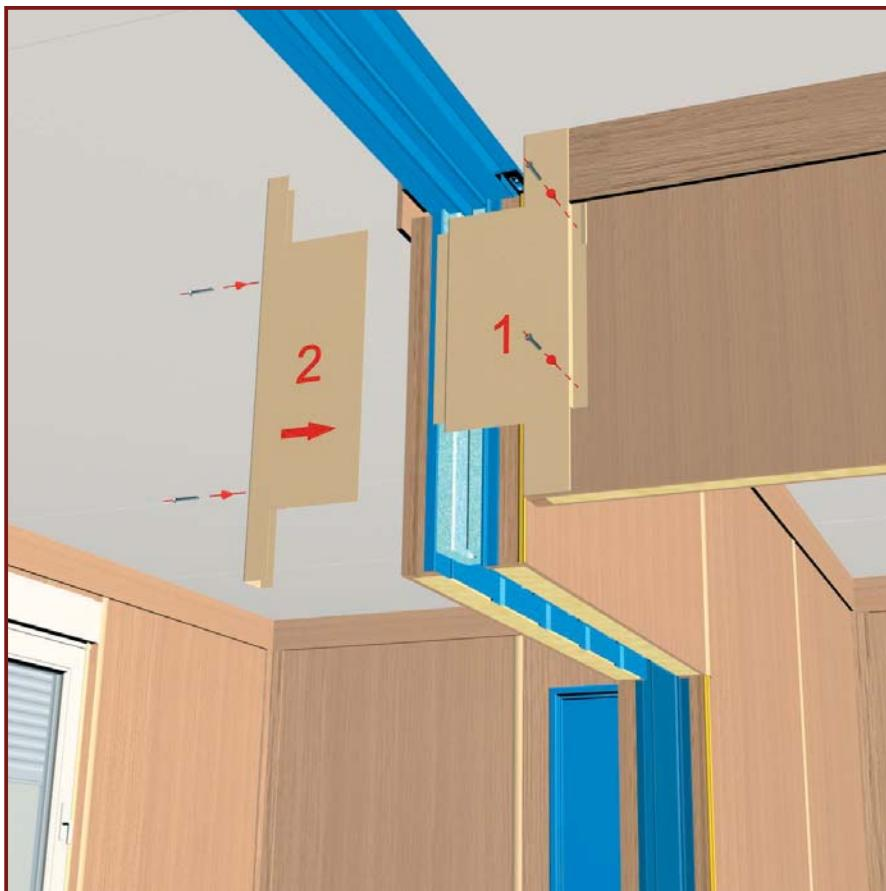
**DE:** 2.) Gangverbindung mit einer Trennwand
