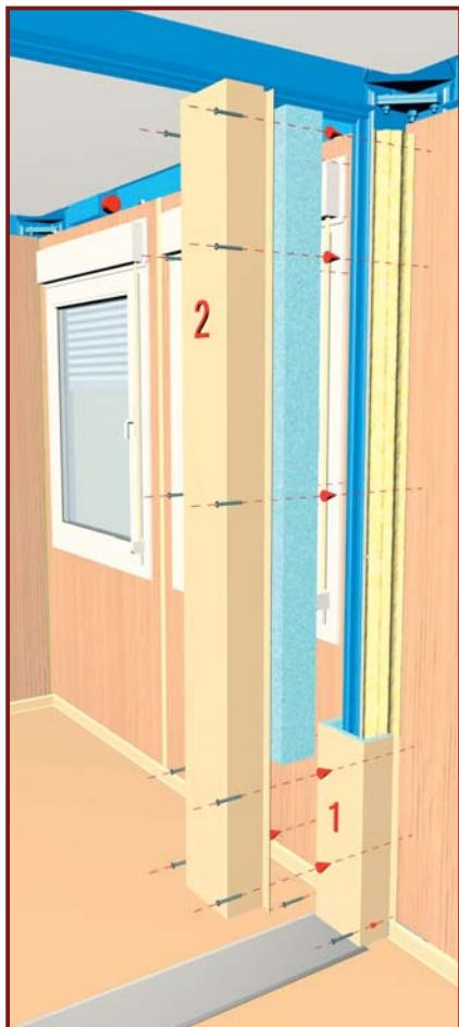
**DE:** Hohlräume im Ecksäulenbereich mit Isoliermaterial ausfüllen.
