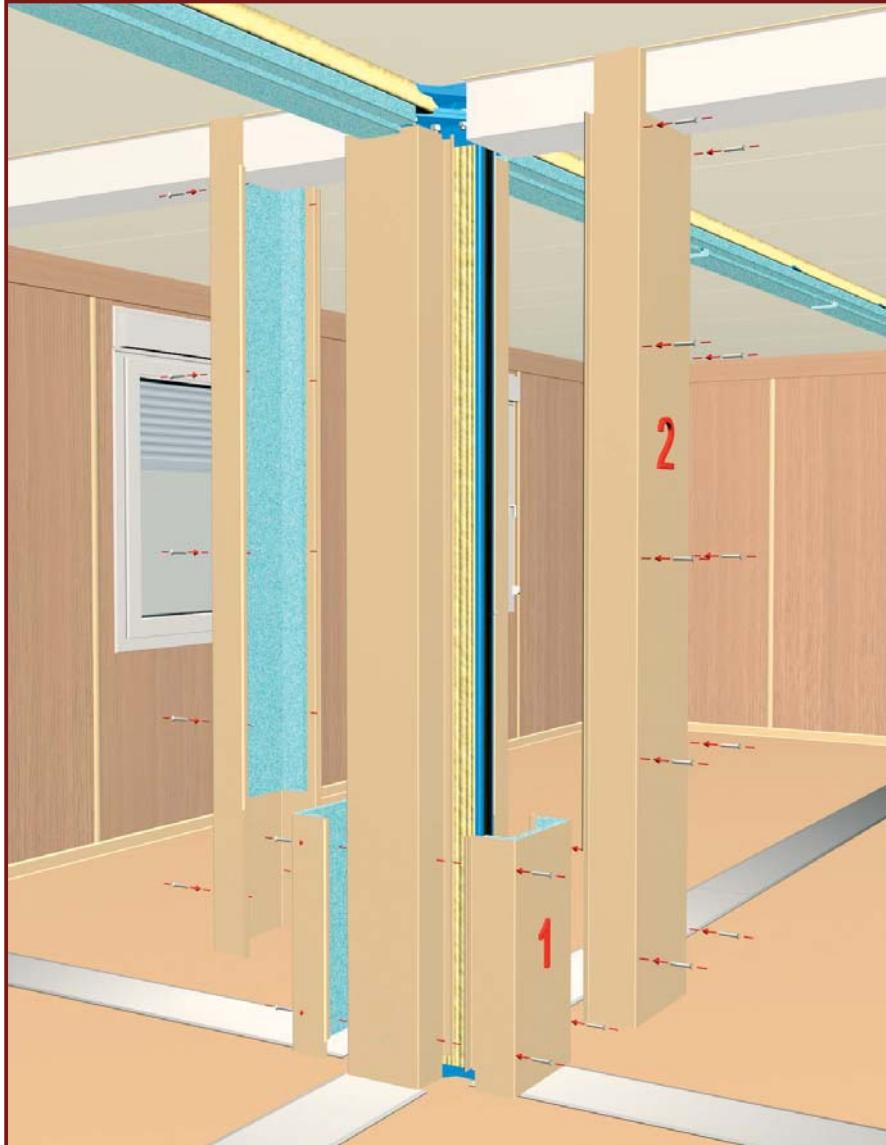
**ES:** Atornillar los túneles laterales con los cantos de goma comenzando con la parte inferior a los ya montados túneles laterales.
