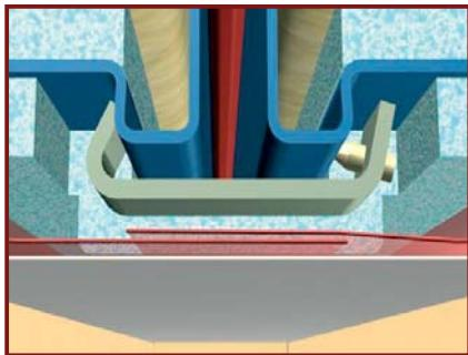
**DE:** Bereiche der Innenspannzangen im Styropor mit Messer freischneiden, die Dachlängsträger mit Innenspannzangen verschrauben. Die Dampfsperren (Folie) überlappend miteinander durchgehend mit Klebeband verkleben.
