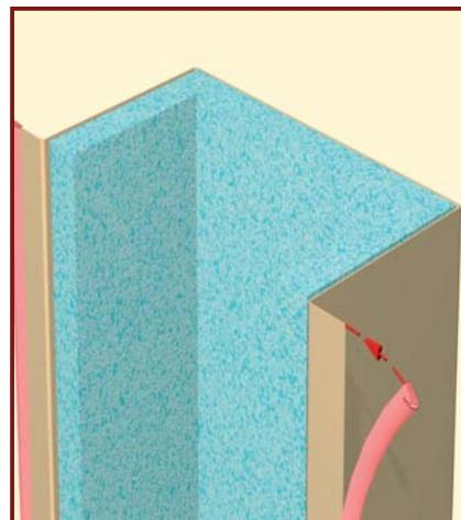
**DE:** Hohlräume im Ecksäulenbereich mit Isoliermaterial ausfüllen. Seitentunnel mit aufgesetzter Lippendichtung, beginnend mit dem unteren Tunnel montieren.
