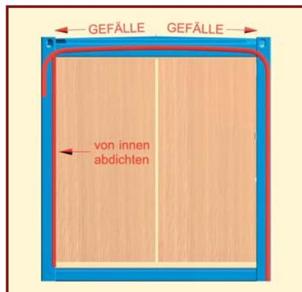
**DE:** Verlauf der Spezial-Gummidichtung bei Container 4 stirnseitig.
