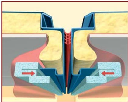
**DE:** Bereiche der Innenspannzangen im Styropor mit Messer freischneiden, die Dachlängsträger mit Innenspannzangen verschrauben. Die Dampfsperren (Folie) überlappend miteinander durchgehend verkleben.
