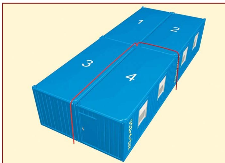
**FR:** Positionner le bungalow 3 et insérer le joint en caoutchouc entre les bungalows 1 et 3 (voir kit d'assemblage sur la largeur).
