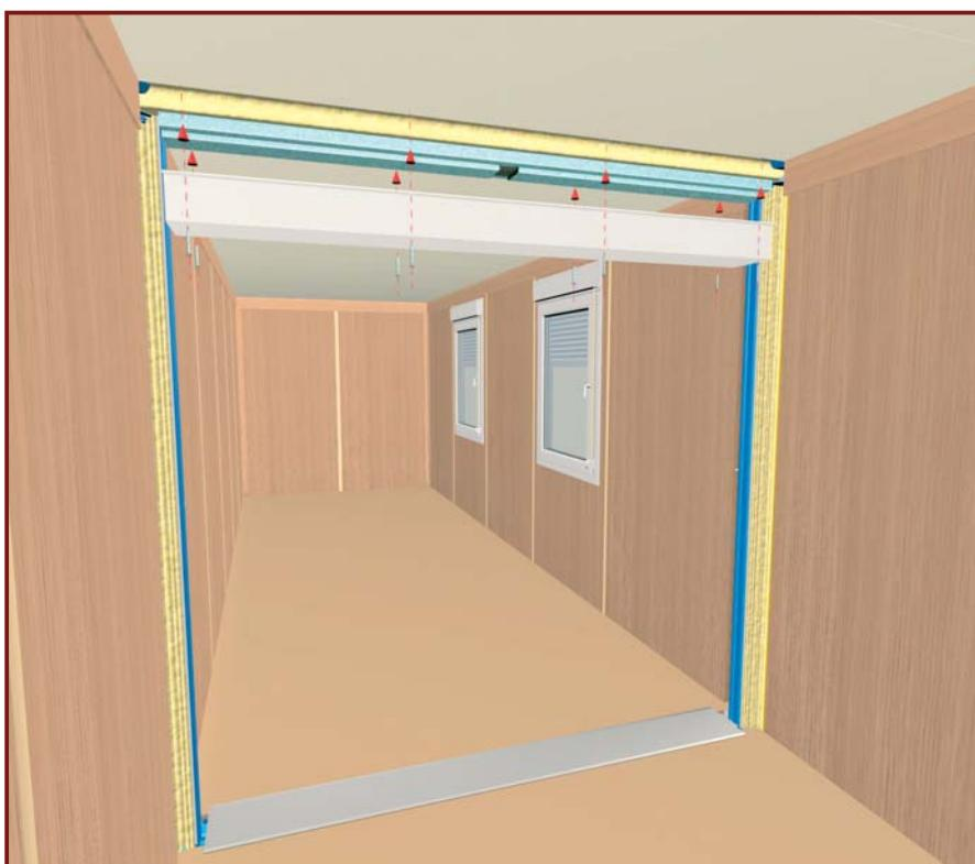
**DE:** Dachtunnel mit aufgesetzter Lippendichtung montieren.
