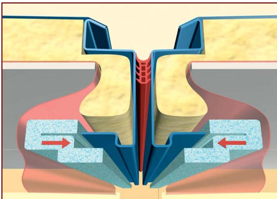
**DE:** Obere Seitentunnel in Position bringen und wie dargestellt mit den Holzleisten und unteren Tunneln verschrauben.
