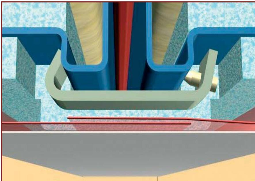
**ES:** Cortar los trozos de poliesterol de la zona de las grapas de sujeción interiores con un cuchillo. Atornillar con grapas tensoras las dos vigas del techo. Superponer las láminas anticondensación una con otra y fijar con una cinta adhesiva.
