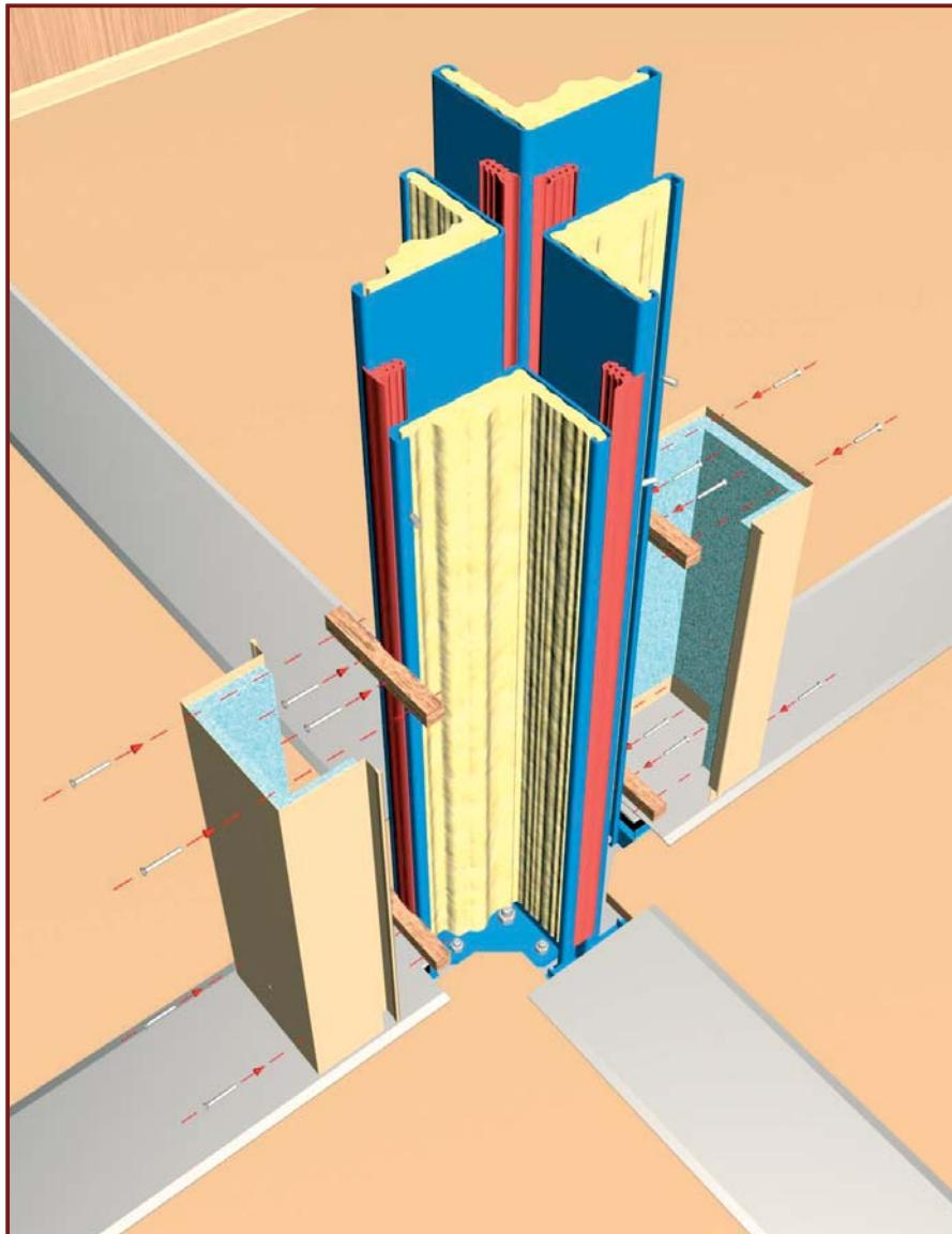
**ES:** Rellenar el espacio hueco del armazón con material aislante. Atornillar los listones de madera a los pilares (parte lateral) como se representa. Atornillar a los listones de madera la parte inferior del túnel lateral con los cantos de goma.
