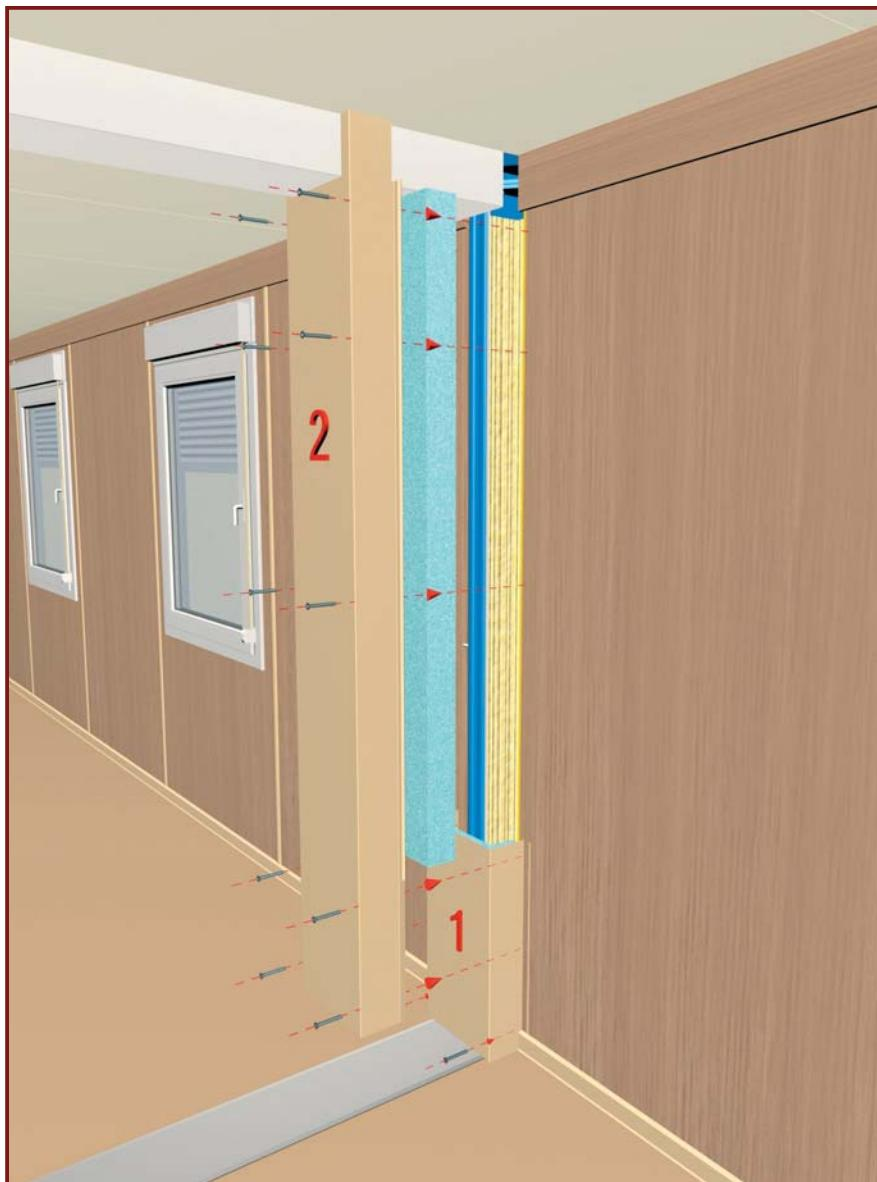
**DE:** Hohlräume im Ecksäulenbereich mit Isoliermaterial ausfüllen. Seitentunnel mit aufgesetzter Lippendichtung, beginnend mit dem unteren Tunnel montieren.
