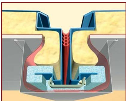
**DE:** Dachtunnel mit aufgesetzter Lippendichtung montieren. Eventuell verbleibende Fugen mit mitgeliefertem Silicon verschließen.
